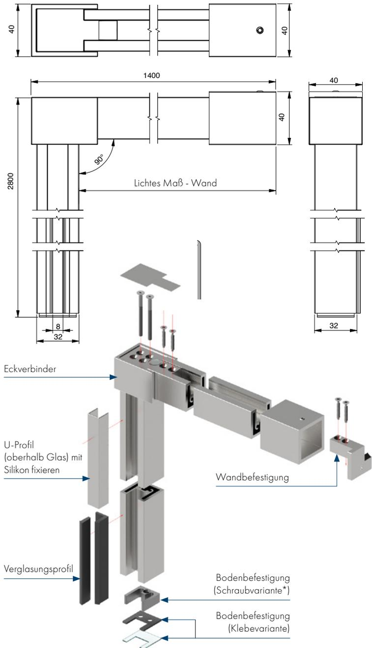
\* Damit die Wasserdichtung im Bad durch das nachträgliche Anbohren der unteren Befestigungsplatte nicht verletzt wird, sollte der Fliesenleger den Befestigungsadapter vorher in den Bodenaufbau einarbeiten und entsprechend der Beanspruchungskategorie die richtige Feuchtraumabdichtung nach den anerkannten Richtlinien ausführen.
