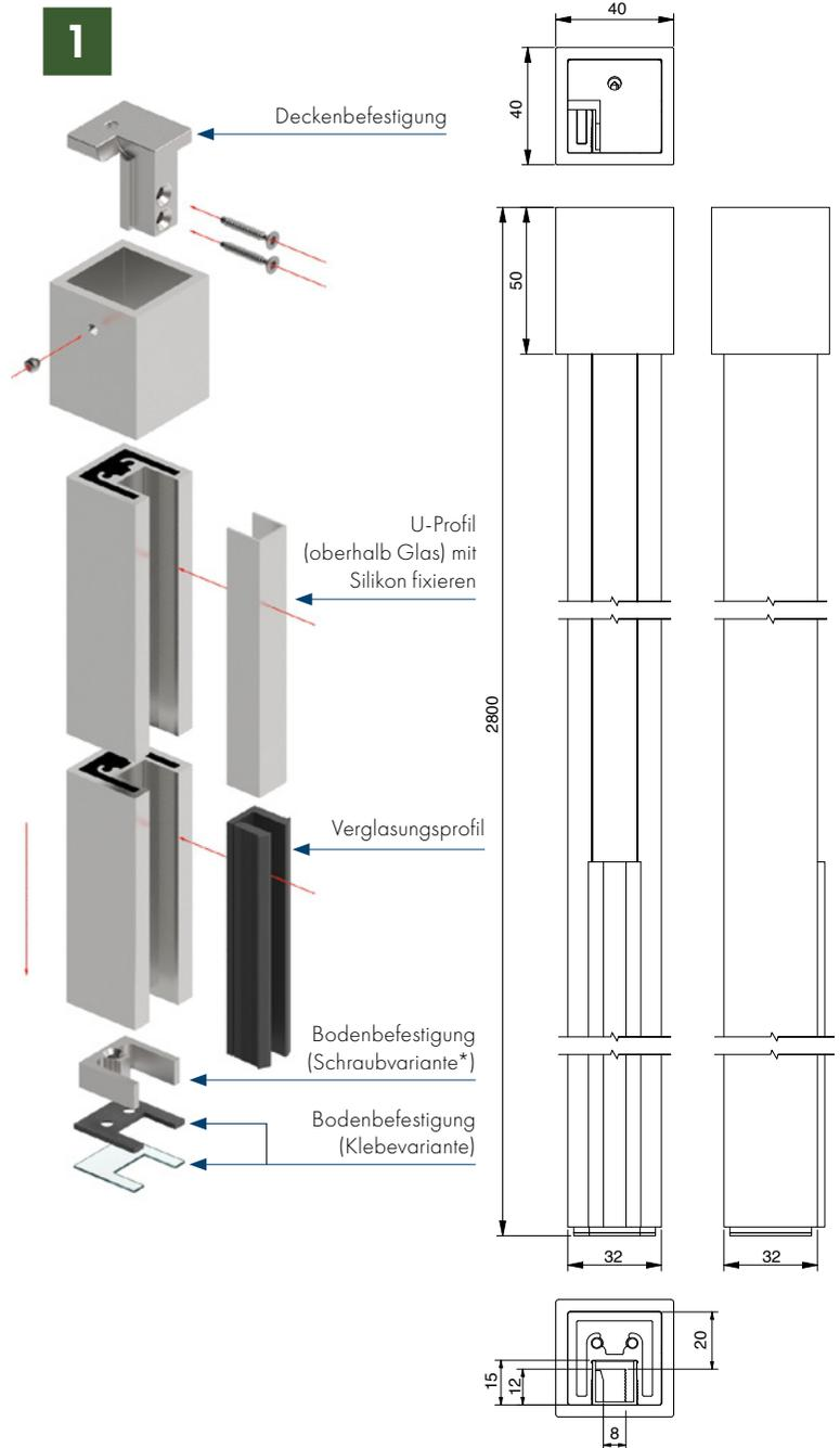
\* Damit die Wassersperre im Bad durch das nachträgliche Anbohren der unteren Befestigungsplatte nicht verletzt wird, sollte der Fliesenleger den Befestigungsadapter vorher in den Boden-aufbau einarbeiten und entsprechend der Beanspruchungsklasse die richtige Feuchtraumabdichtung nach den anerkannten Richtlinien ausführen.
