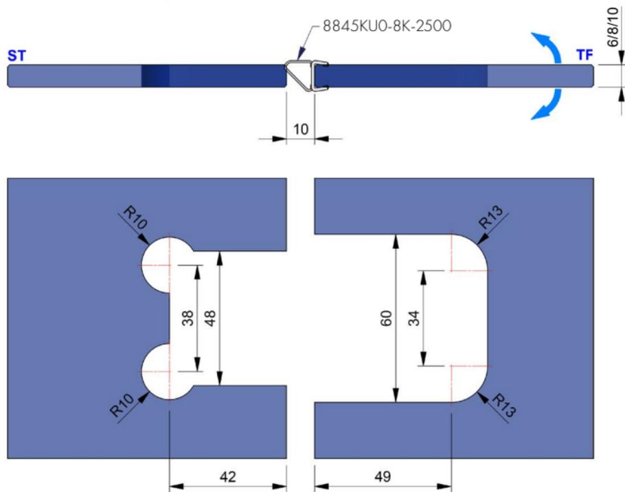
Glasbearbeitung mit Dichtprofil 8857KU0-8-2010
