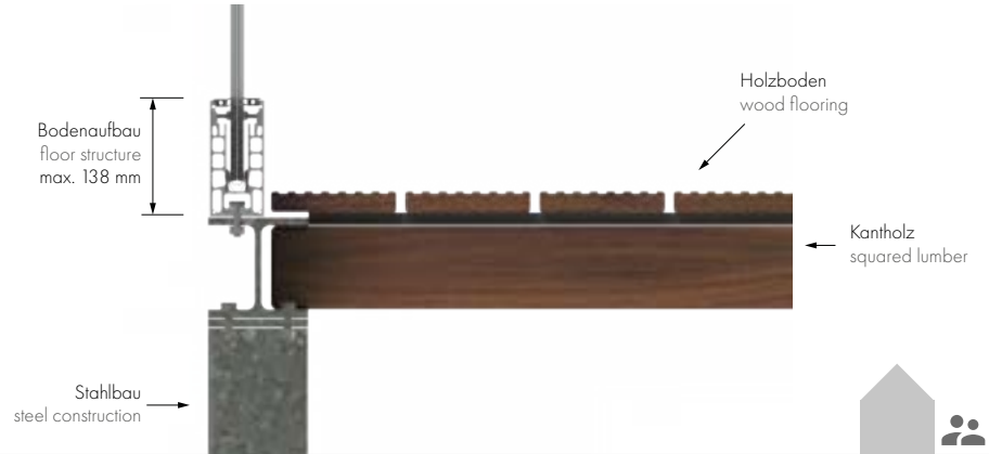
(C) Außenanwendung: Beispiel vorgesetzter Anbaubalkon exterior application: example front mounted balcony
