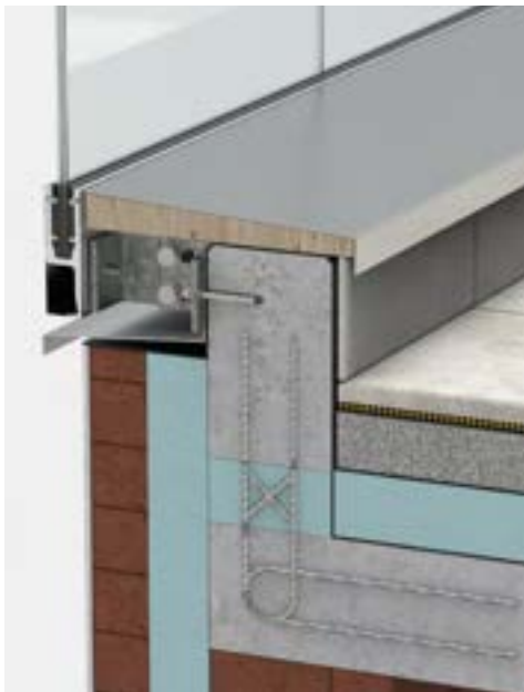
(C) Außenanwendung: Beispiel Balkon-Attika mit Betonelementen gedämmt exterior application: example balcony attika insulated with concrete elements
