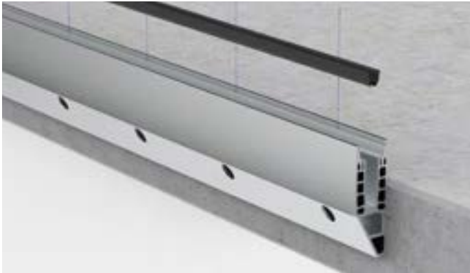
2. Unteres Verglasungsprofil einsetzen (im Außenbereich an den bauseitig hinzugefügten Entwässerungsbohrungen aussparen) insert lower glazing profile (for outdoor usage, blank out at the drainage holes. drainage holes drilled on site)
