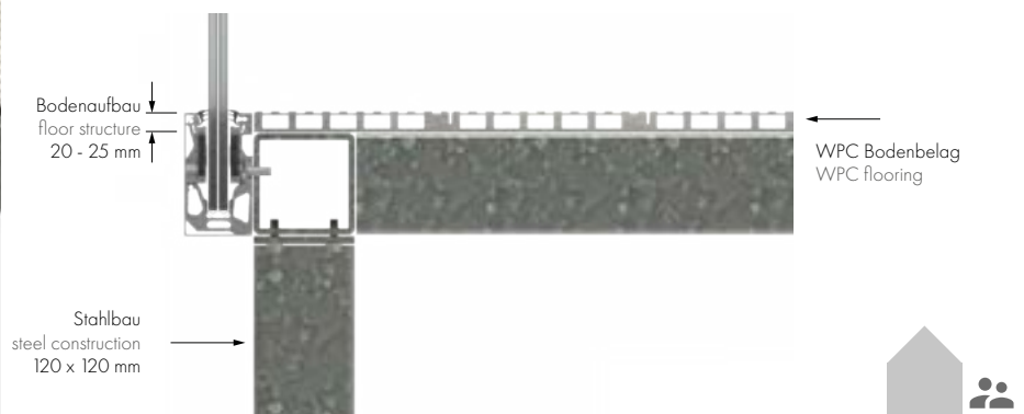
(A) Außenanwendung: Beispiel vorgesetzter Anbaubalkon exterior application: example front mounted balcony
