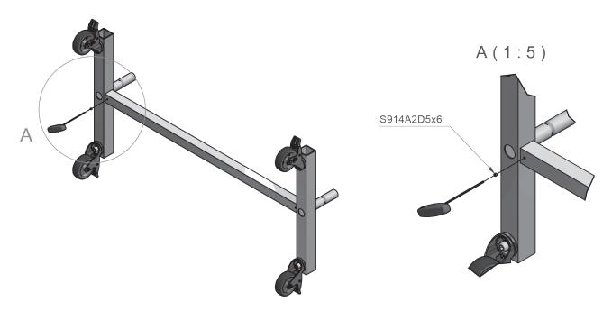
6. Schlagen Sie die Deckel 10308700 ein. Gegebenfalls nutzen Sie dazu Loctite 1023310CTP. Tap in the caps 10308700. If so desired, use Loctite 1023310CTP.
