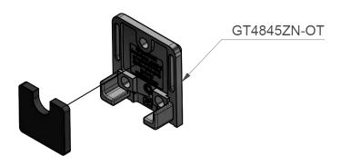
10. Verschrauben Sie die Unterteile der Klemmbefestigung auf die Proile 3051-1VA. Fasten the lower part of the clamp fixtures to the profiles 3051-1VA.
