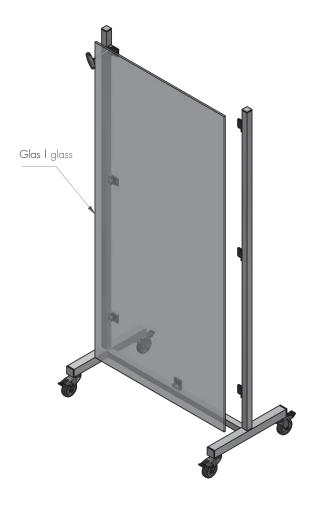
15. Befestigen Sie das Glas mit dem Oberteil der Klemmbefestigung. Secure the glass with the upper part of the Clamp fixtures
