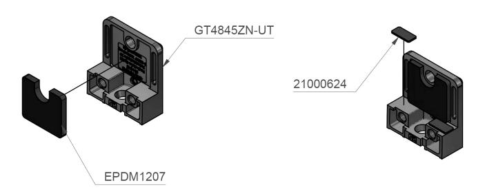
**9.** Kleben Sie das EPDM1207 in das Oberteil GT4845ZN-OT der Klemmbefestigung. Adhere the EPDM1207 in the upper part of the clamp fixture GT4845ZN-OT.
