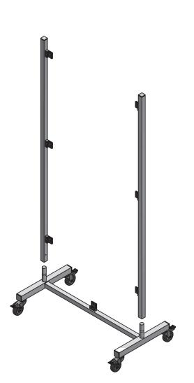
13. Befestigen Sie die Profile mit den Madenschrauben S914A2D5x6.
