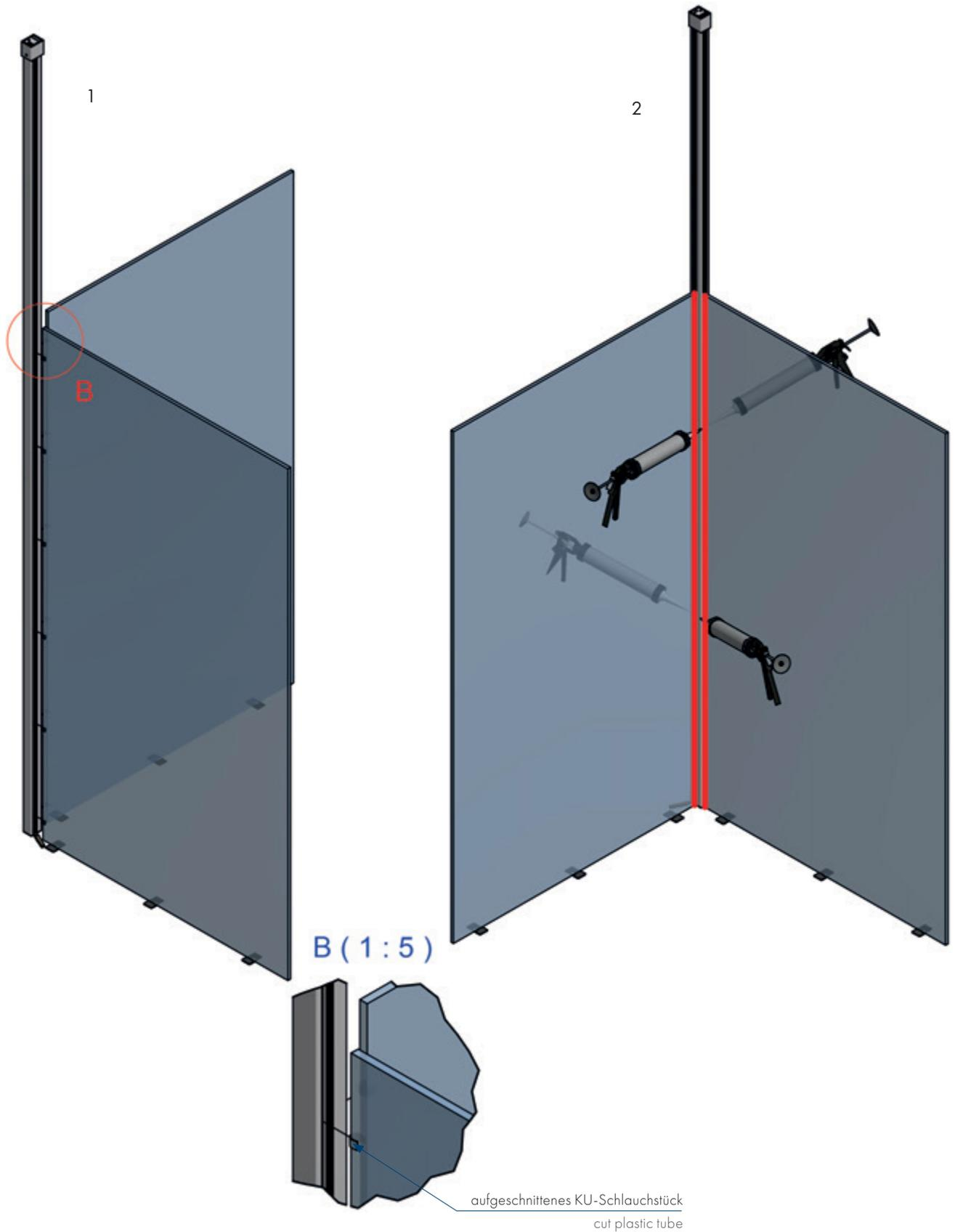
Bei Verwendung von 10 oder 12 mm Glas stellen Sie das Glas auf Weich-PVC und setzen Sie auf die Glaskante aufgeschnittene KU-Schlauchstücke. Schieben Sie das Glas in das Profil und versiegeln Sie das Glas mit Silikon im Profil.
