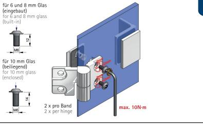
Die Befestigungsschrauben mittig in den Bohrungen positionieren, um den grösstmöglichen Verstellbereich für die Einstellung der Dusche zu gewährleisten. Benötigtes Werkzeug: Innensechskantschlüssel SW4mm. Wechselweise bis zum Erreichen des max. Anzugsmomentes von 10N·m anziehen. Nach ca. 15 Minuten noch einmal wechselweise auf das max. Anzugsmoment nachziehen.
