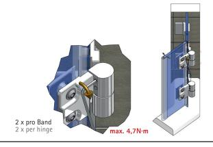
Wenn der Türflügel ausgerichtet ist und alle Dichtprofile aufgesteckt wurden, kann die Nulllage eingestellt werden. Bei Verwendung von Magnetdichtprofilen sollte die Nulllage mit etwas Vorspannung eingestellt werden. Dabei sind die Madenschrauben wechselweise auf das angegebene Anzugsmoment anzuziehen und nach ca. 15 Minuten nachzuziehen. Benötigtes Werkzeug: Innensechskantschlüssel SW2.5mm.
