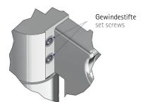
Bitte achten Sie vor der Montage bei allen Nivello- und Nivello+-Duschbändern darauf, daß die beiden Gewindestifte zur Nulllageneinstellung weit genug heraus gedreht sind und keinen Kontakt zu den inneren Bauteilen der Nulllageneinstellung haben.
