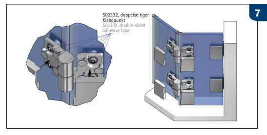
Zur Fixierung der Abdeckkappe 8360-1ZN-L liegen den Beschlägen doppelseitige Klebepunkte, Best.-Nr. 502332, bei. The fittings are provided with double-sided adhesive tape for fixing the 8360-1ZN-L cover plate. (art. no. 502332)
