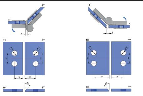
Glasbearbeitung für 8 mm Glas mit Dichtprofil 8860KU0-8 for 8 mm glass with sealing profile 8860KU0-8
