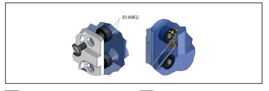
Beim Austauschen der Kunststoffschlauchstücke gegen die Exzenterbuchsen muss der Türflügel unterklotzt sein, um ein Abrutschen des Glases zu verhindern. Die Exzenterbuchsen werden durch Verdrehen der beiden Exzenterteile an die Position der Schraube bzw. des Führungszapfens in der Glasbohrung angepasst. Bitte vermeiden Sie dabei eine zu grosse seitliche Auslenkung. Für das Einstellen der Zentierbuchsen sind Aufnahmen für 1,5mm-Innensechskantschlüssel in den Exzenterhuchsen vorhanden.
