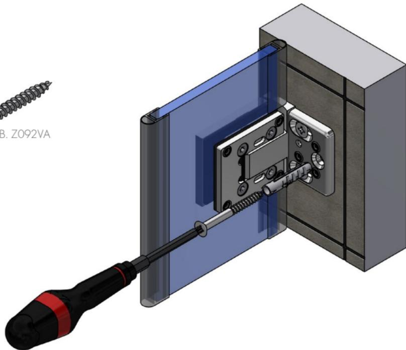
Wichtig: Die Schrauben sollten aus Edelstahl A2 oder A4 bestehen und einen Senkkopfdurchmesser von min. 10 mm und max. 12 mm aufweisen. Bitte die entsprechende Kopfhöhe prüfen, so dass die Schrauben das Befestigen der Abdeckplatte 8900-18ZNT, am Ende der Duschenmontage, nicht behindern
