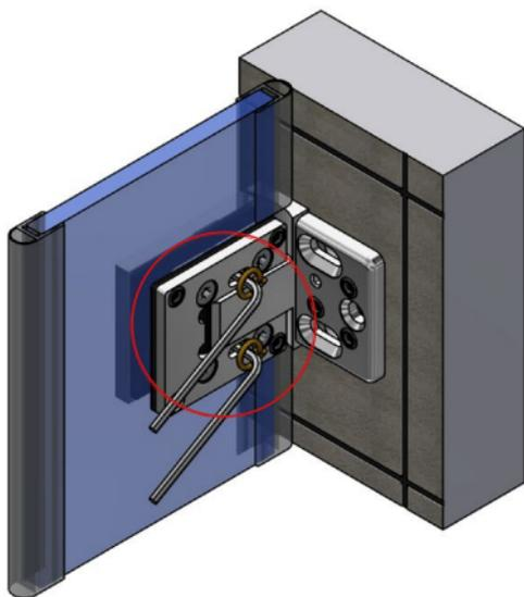
Die Gewindestifte zur Nulllageeinstellung können zusätzlich mit Schraubensicherung fixiert werden.
