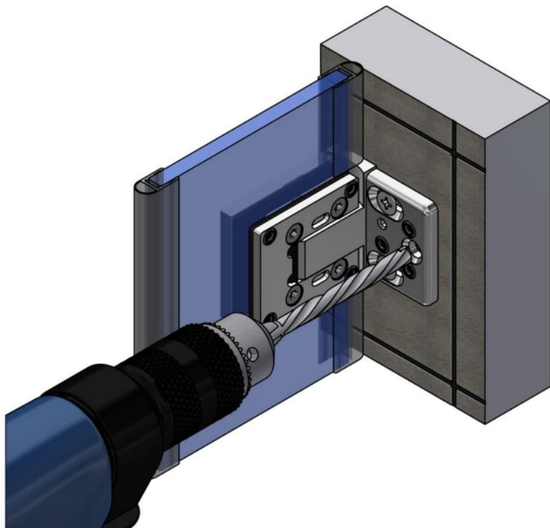
Ist die Dusche fertig aufgebaut und ausgerichtet, können die Bänder endgültig fixiert werden. Das Duschband ist so konstruiert, dass die Befestigungsbohrung mit einem 8mm Bohrer im montierten Zustand ausgeführt werden kann.
