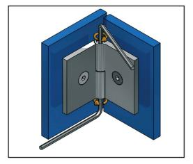
Nach dem Ausrichten der Dusche werden die Schrauben zur Winkelfeststellung (max. 6N.m) und alle Schrauben bis zum Erreichen des max. Anzugsmomentes von 10N.m angezogen.
