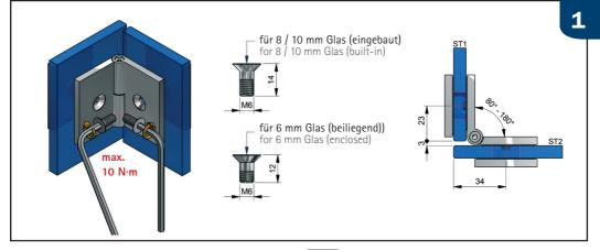
Die Befestigungsschraube mittig in der Bohrung positionieren, um den grösstmöglichen Verstellbereich für die Einstellung der Dusche zu gewährleisten. Danach ist das Seitenteil mit den montierten Winkeln auf 2mm Weich-PVC o. ä. Unterlegematerial (z.B. 8870KUO) an der gewünschten Position aufzustellen und auszurichten.
