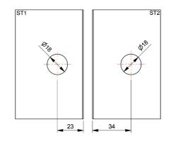
Glasbearbeitung für 8 mm Glas bei 90° glass processing for 80 mm glass at 90°
