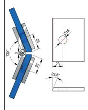
Gehrungswinkel und Bohrlochmaße für 8175ZN miter square and bore hole dimensions for 8175ZN
