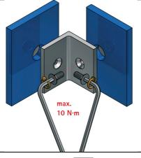
Die Befestigungsschraube mittig in der Bohrung positionieren, um den grösstmöglichen Verstellbereich für die Einstellung der Dusche zu gewährleisten. Danach ist das Seitenteil mit den montierten Winkeln auf 2mm Weich-PVC o. ä. Unterlegematerial (z.B. 8870KUO) an der gewünschten Position aufzustellen und auszurichten.
