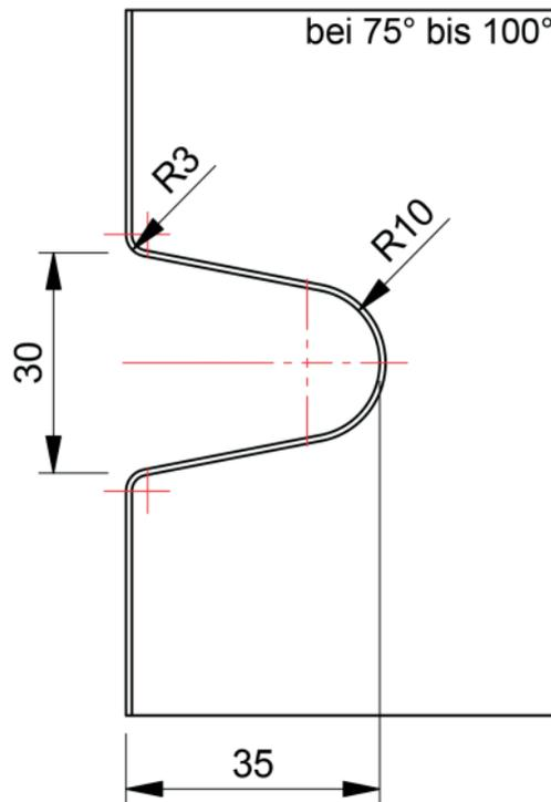
**Gehrungswinkel und Bohrlochmaße für 8171ZN | miter square and bore hole dimensions for 8171ZN**
