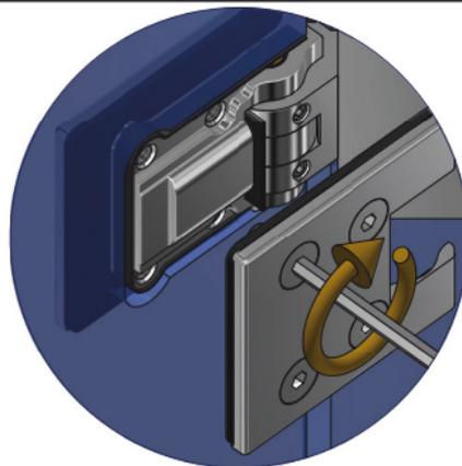
Glaserklötzchen verwenden, um ein Anschlagen der Gläser bei der Montage zu verhindern. Bitte auf das Spaltmaß der gewünschten Dichtungslösung achten (siehe Anhang)
