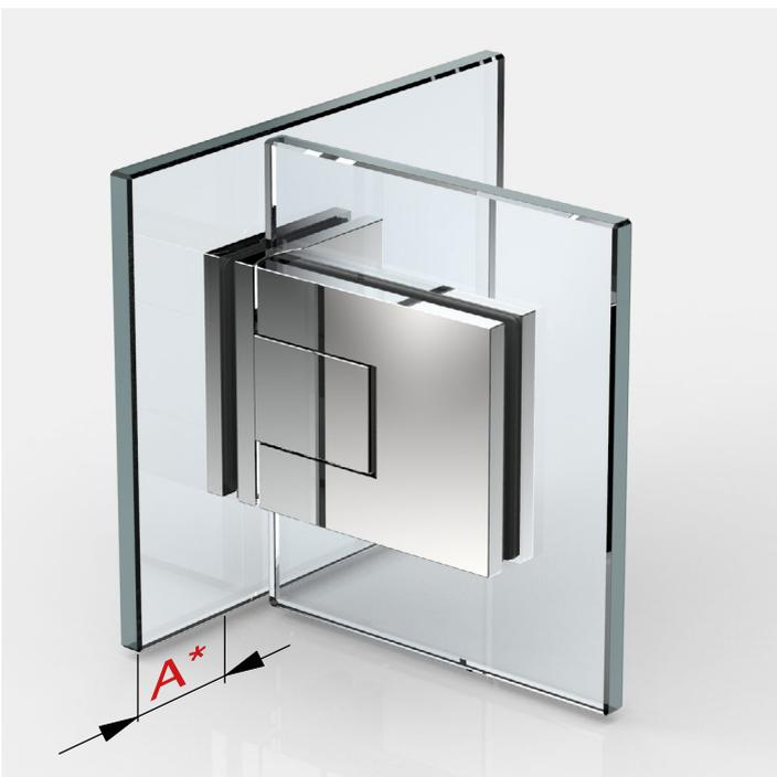
Beim Beschlag Glas-Glas 90° sind nur Glasbohrungen im Seitenteil vorgesehen, dadurch ist ein Einrücken des Glastürflügels nach innen möglich und der Überstand (A) kann selbst bestimmt werden.
