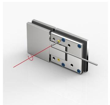
Wenn der Türflügel ausgerichtet ist und alle Dichtprofile aufgesteckt wurden, kann die Nulllage eingestellt werden. Dabei sind die Schrauben beider Nulllagen wechselweise auf das angegebene Drehmoment anzuziehen und nach ca. 15 Minuten nachzuziehen. Dies ermöglicht eine Einstellung des Schließpunktes auch bei nicht rechtwinkligen Wänden. Alle wichtigen Hinweise hierzu entnehmen Sie bitte den jeweils beiliegenden Montageanleitungen.
