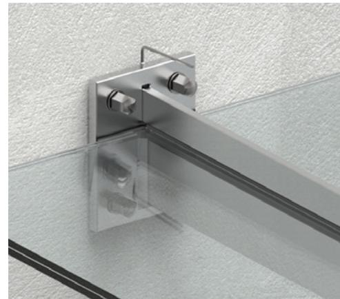
4. Die Befestigungsschrauben so weit hineinschrauben, bis es zu einem Kontakt zwischen oberer Deckleiste und Glasscheibe kommt. Im weiteren Verlauf die Schrauben nur noch so weit anziehen, dass die obere Deckleiste sich in ihrer Form (Bogen im mittleren Bereich) nicht verbiegt.
