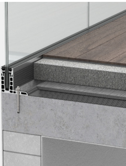
(E) Innenanwendung: Beispiel Empore/Laubengang mit eingelassenem Profil interior application: example porch / portico with recessed profile
