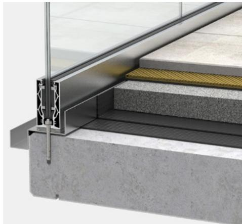
**(B) Außenanwendung:** Beispiel Balkon mit Betonelementen, Gefälle nach außen
