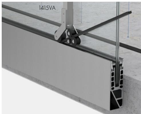
6. Blende (1) und oberes Verglasungsprofil\* (2) einsetzen
