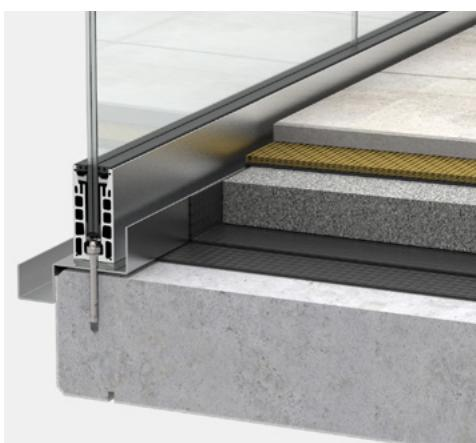
**(B) Außenanwendung:** Beispiel Balkon mit Betonelementen, Gefälle nach außen
