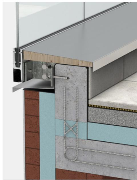
**(C) Außenanwendung:** Beispiel Balkon-Attika mit Betonelementen gedämmt
