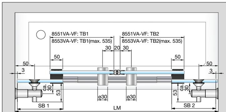
Set 8551VA-VF: Einfachlaufrohr, Nische, Wandhalter flächenbündig, bis 2000 mm
