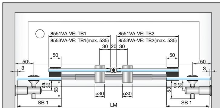
Set 8551VA-VE: Einfachlaufrohr, Nische, Wandhalter erhaben, bis 2000 mm
