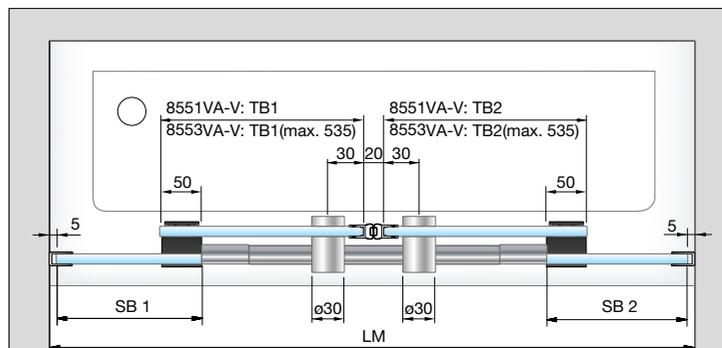
Set 8551VA-V: Einfachlaufrohr, Nische, U-Profil, bis 2000 mm
