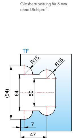
Glasbearbeitung für 8 mm ohne Dichtprofil
