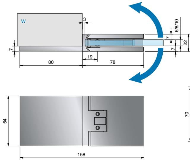
Glasbearbeitung für 8 mm ohne Dichtprofil
