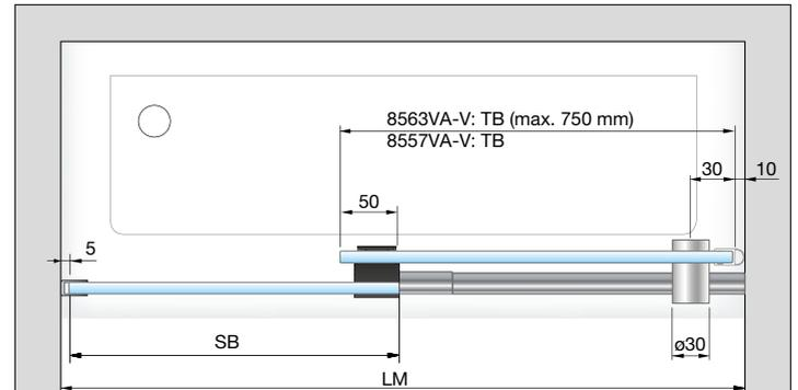
Set 8563VA-V: Einfachlaufrohr, Nische, U-Profil, bis 1200 mm
