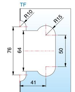
Glasbearbeitung für 8 mm mit Dichtprofil 8861KU0-8-2010
