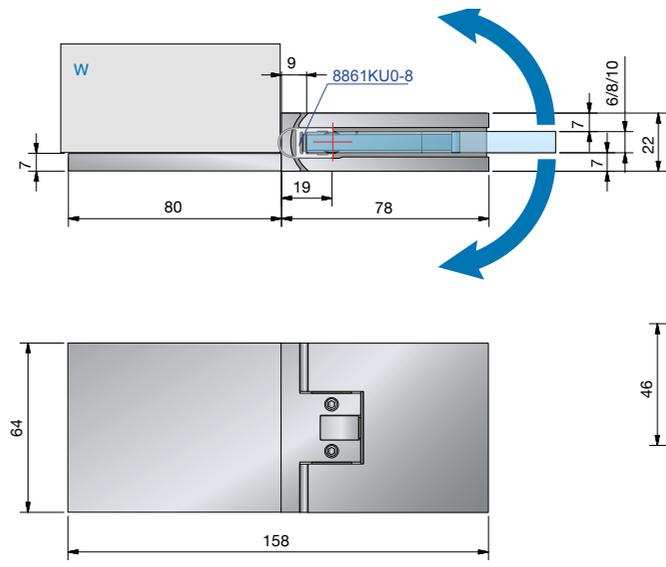
Glasbearbeitung für 8 mm mit Dichtprofil 8861KU0-8-2010
