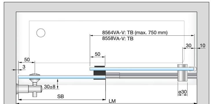
Set 8564VA-V: Einfachlaufrohr, Nische, Wandhalter erhaben, bis 1200 mm
