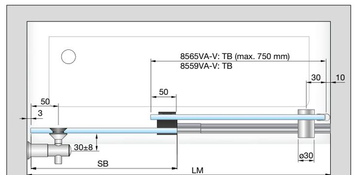
Set 8565VA-V: Einfachlaufrohr, Nische, Wandhalter flächenbündig, bis 1200 mm
