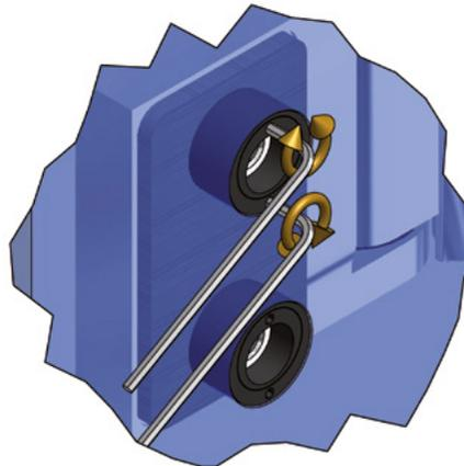
Durch den Einbau des Doppelexzentereinsatzes kann das Glas besser zentriert und dauerhaft positioniert werden.
