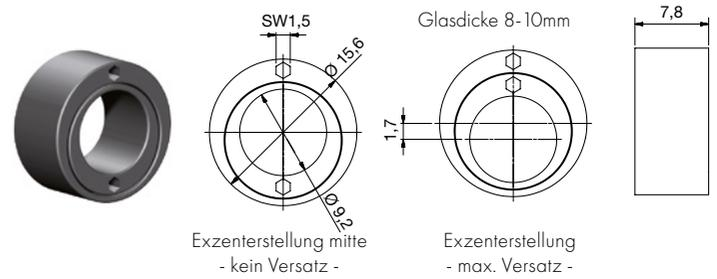
Exzenterstellung frei wählbar, Verstellung mittels Innensechskantschlüssel SW1,5mm
